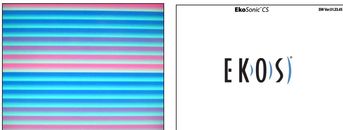
Afbeelding 3. Eerste schermen van de EkoSonic bedieningseenheid tijdens de zelftest.
