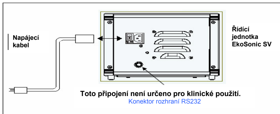
Obrázek 17. Schéma propojení na zadním panelu řídicí jednotky EkoSonic
